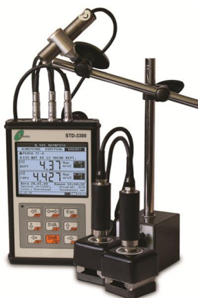
Рис. 1. Переносной анализатор вибрации STD-3300.
